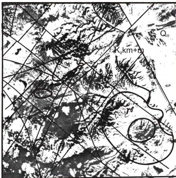
Рис.2. Характер дешифрируемости линейных и кольцевых структур в пределах Мехманинского рудного района (аэрофотоснимок мелкого масштаба).
